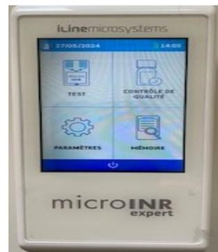
Wählen Sie « QC », dann «EQA Test». Setzen Sie den Test-Chip ein und warten Sie auf den Countdown.
