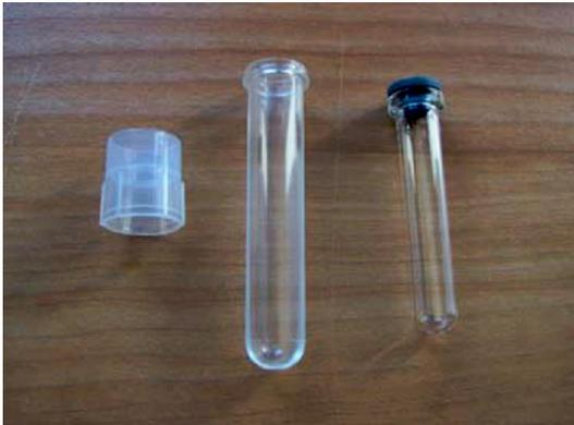
Füllen Sie mit einer Pipette das jeweilige Ringversuchsmaterial in den Innenbehälter des «Empty Tube Kit» und beschriften Sie den Behälter.
