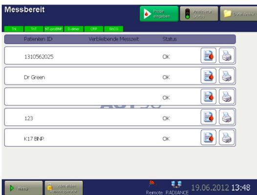
Der AQT90 FLEX muss im Modus «**Messbereit**» sein. Der Analysator Status und alle Parameter müssen auf grün stehen.
