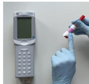
3. Incliner doucement le flacon en position bouchon vers le bas et agiter l'échantillon ; remettre en position bouchon vers le haut et agiter.
