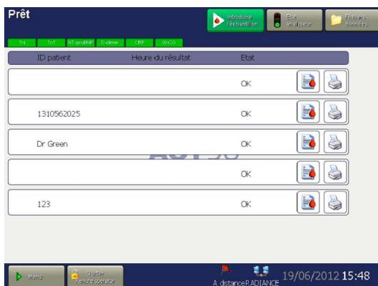
L'AQT90 Flex doit être en mode «**Prêt**». L'état de l'analyseur et tous les paramètres doivent être **verts**.
