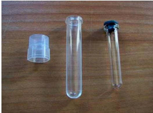
Avec une pipette, transférer chacun des échantillons dans le tube **intérieur** des «Empty Tube Kit» et les identifier.
