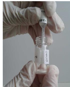
Mélanger délicatement le contenu du flacon par un mouvement de rotation manuelle jusqu'à ce que le lyophilisat soit totalement dissout. **Attention**, ne pas secouer, ni renverser sur les côtés ou retourner le flacon.
